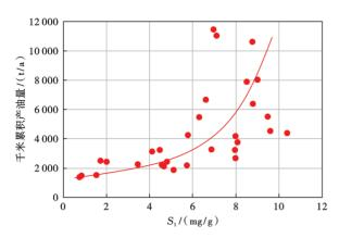
图 2 黄骅坳陷页岩油水平井压裂段平均  $S_1$  与水平段 折算千米累积年产油量关系
