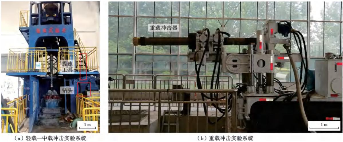
图 1 冲击破岩室内实验测试系统
