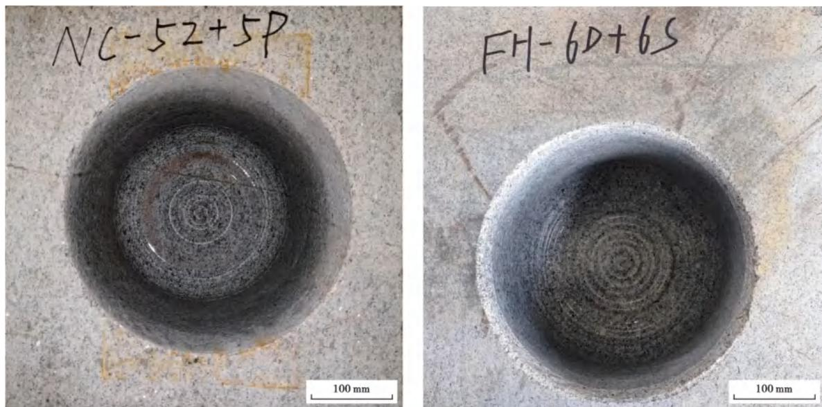
(a) 轻载冲击破岩井底 (b) 中载冲击破岩井底
