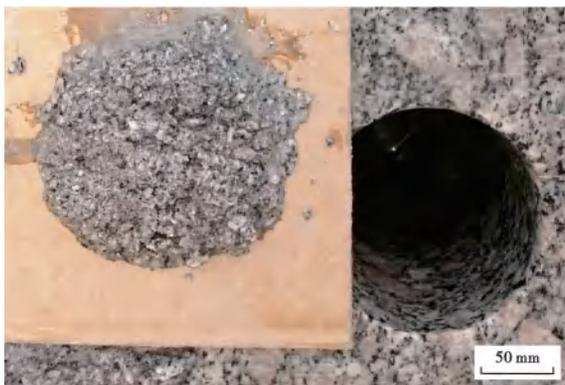
图 7 重载冲击器破岩井底及岩屑
