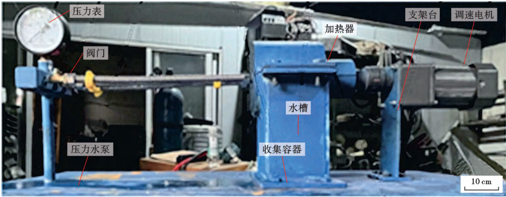
图 16 牙轮钻头螺旋磁流体复合密封试验装置的主体结构
